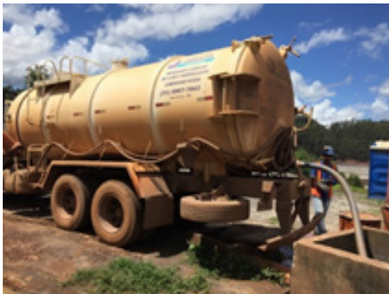
Caminhão do tipo limpa fossa despejando efluente sanitário na ETE 01 Fonte: Samarco, 2016.
