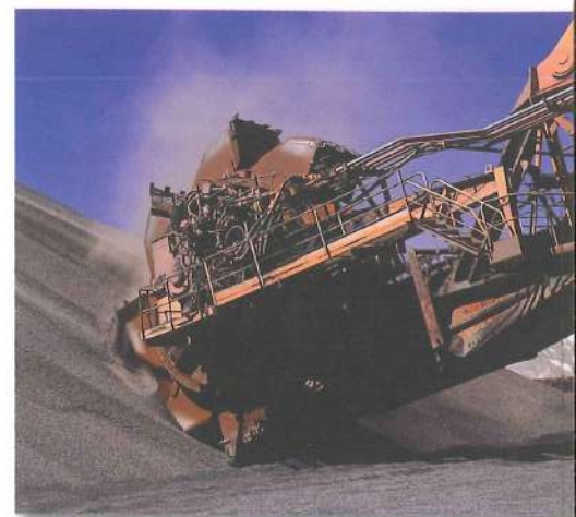
A retomadora retira as pelotas do pátio de estocagem em Ubu, transferindo-as para uma esteira que segue diretamente para o embarque
